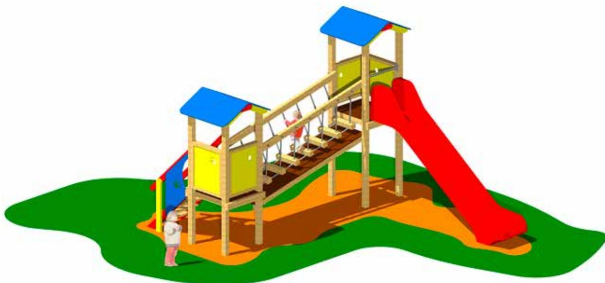
Gioco con struttura in legno con ponte mobile e scivolo in polietilene.
